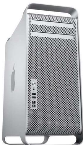
Die ältere Mac Pro Generation (2006-2013) ist mit Xeon Prozessoren ausgestattet (Wahlweise ein oder zwei) und bietet auch in heutigen Massstäben genug Leistung für Cenplex. Die Empfehlung ist teils negativ, da die älteren Modelle über langsame Festplatten verfügen.
