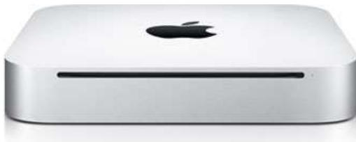
Die erste Generation aus „unibody“ Aluminium bietet je nach Konfiguration mittels optionalem RAM Upgrade auf 8GB und Unterstützungsmöglichkeit für SSD Festplatten genug Leistung für den Betrieb von Parallels und Windows 10.
